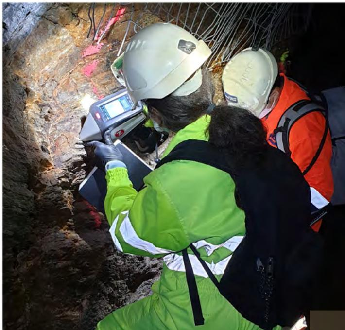
Test d'utilisation d'un spectromètre LIBS (Laser Induced Breakdown Spectroscopy) portable dans une galerie minière en Espagne. L'objectif est de définir les capacités des outils portables à mesurer les compositions chimiques ou minéralogiques des roches directement sur le terrain, que ce soit en mine, sur affleurement ou sur une carotte de forage. Cela nécessite la validation de protocole d'utilisation des instruments et de calibration de la mesure qui sont le cœur de l'Axe 3 du LabCom CREGU.
