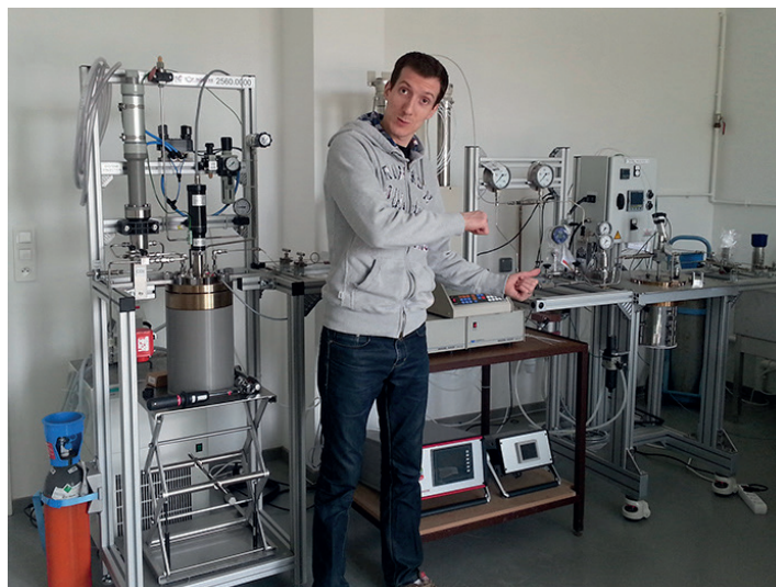
Dispositif expérimental MIRAGES2 dédié à l'étude de l'injection de CO 2 dissous dans des aquifères salins. Ces expériences s'inscrivent dans le cadre du couplage géothermie / séquestration géologique de CO 2
