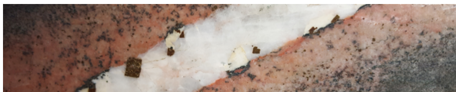
Veine de quartz aurifère (Yaou, Guyane) caractérisée par une forte altération proximale à pyrite aurifère. La carotte de forage bordée d'une altération proximale mesure 5 cm.
