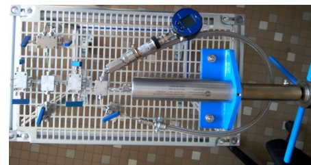
Ligne de pressurisation 2 e génération
