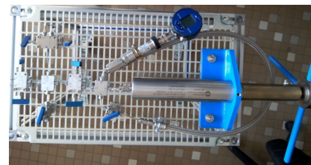
Ligne de pressurisation 2 e génération
