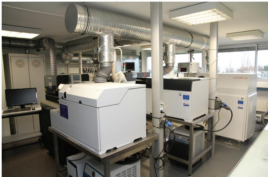
*Vue d'ensemble du laboratoire avec au premier plan de gauche à droite, i) ICP-MS quadripolaire Agilent 7500, ii) ICP-MS triple quadropole Agilent 8900, iii) ICP-MS haute résolution à secteur magnétique Attom-Nu Instruments. Au second plan, lasers excimer 193 nm NWR et GeoLas.*
