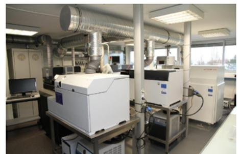
Vue d'ensemble de la plateforme avec au premier plan de gauche à droite, i) ICP-MS quadrupolaire Agilent 7500, ii) ICP-MS triple quadrupole Agilent 8900, iii) ICP-MS haute résolution à secteur magnétique Attom-Nu Instruments.
