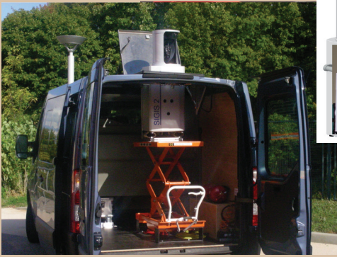
Unité mobile de télédétection des gaz atmosphériques
