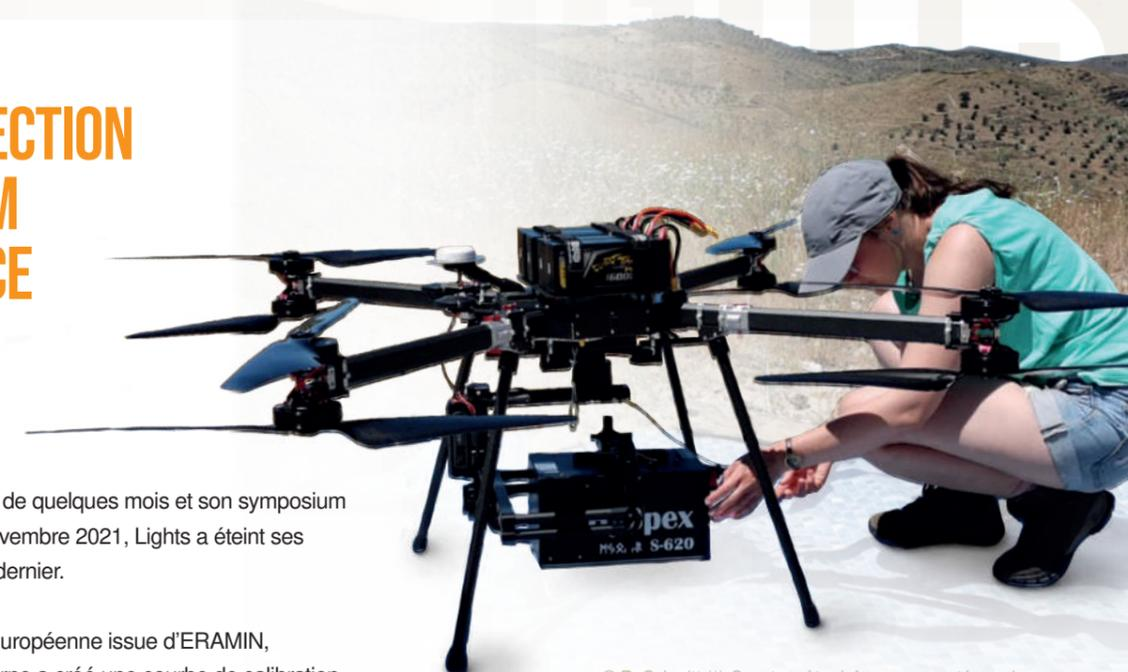
© R. Schmitt /// Spectromètre infrarouge monté sur drone
